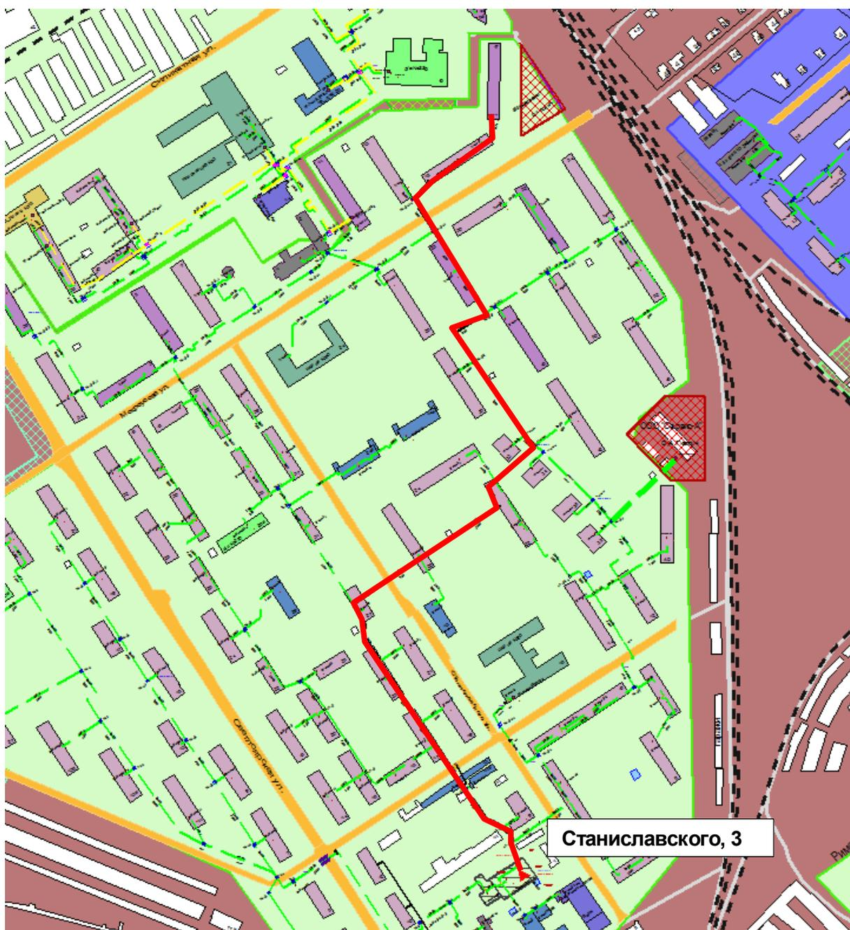
Рисунок 0.49 – Результат гидравлического расчета - расчетный путь теплоносителя от котельной Станиславского, 3 до ПТ-Мокр,17
