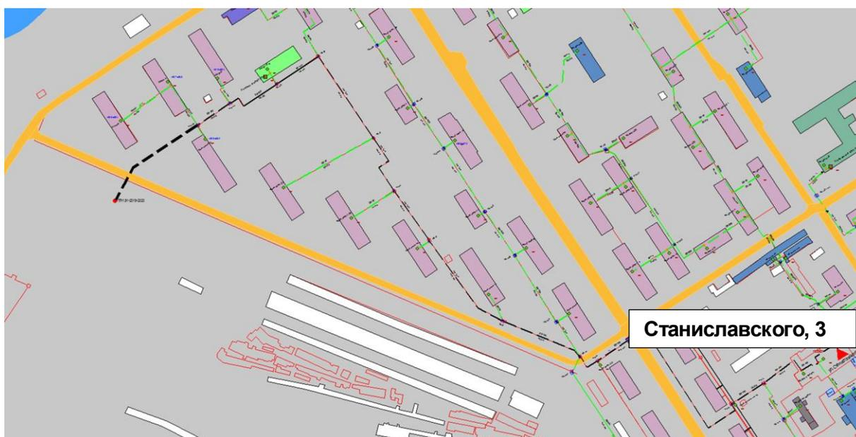
Рисунок 0.47 – Результат гидравлического расчета - расчетный путь теплоносителя от котельной Станиславского, 3 до ПТ-ПП-1,91-2019-2020
