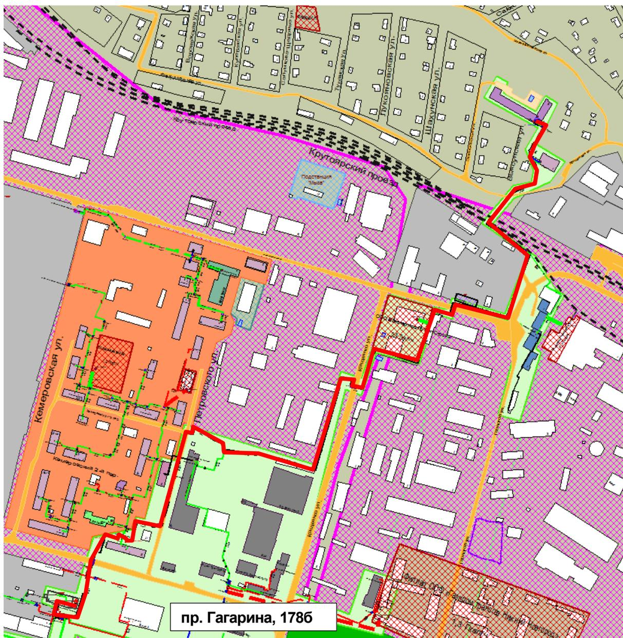
Рисунок 0.114 – Результат гидравлического расчета - расчетный путь теплоносителя от котельной пр. Гагарина, 1786 до ЦТП-706
